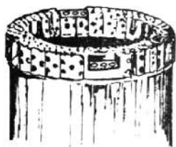
Figura 21 – Coroa com diamantes cravados (coroa com saída d'água do tipo frontal).
