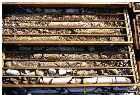
Figura 39 – Amostra de granito alterado obtido por técnicas tradicionais de amostragem 66 mm de diâmetro.
