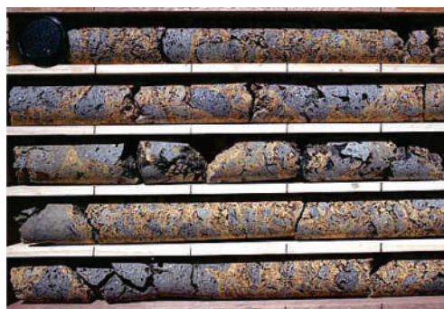
Figura 36 – Amostra de brecha vulcânica obtida por sondador de alta experiência.
